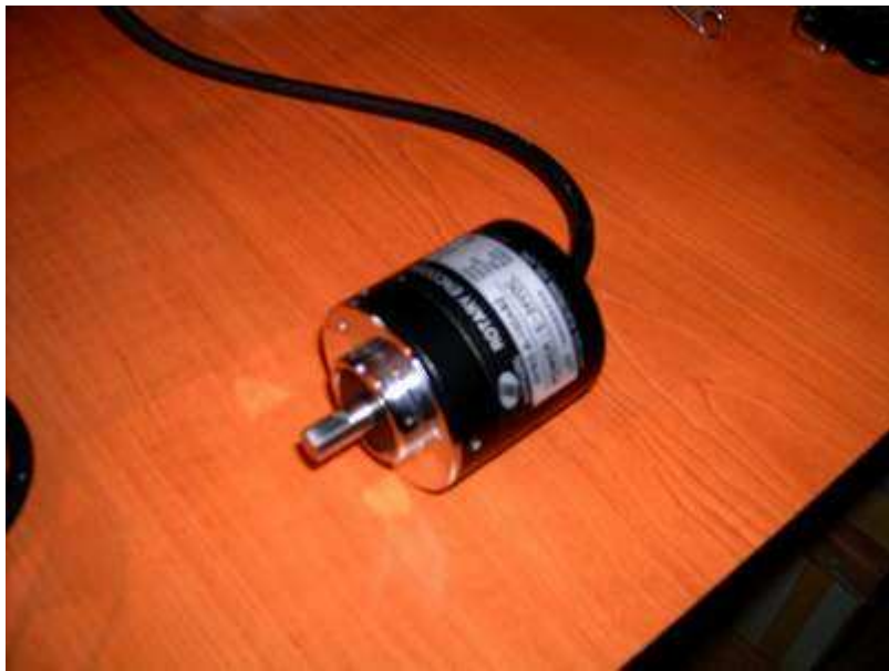
7. kép. A Hanyoung HYRE-A-100ABZ inkrementális jeladó.
